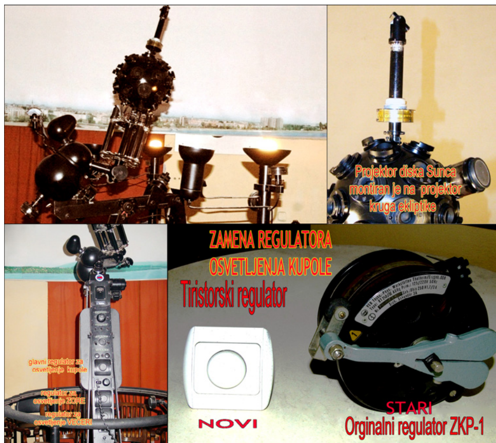
Слика 7: Оптички системи пројектора ZKP-1 на којима је урађена адаптација.
